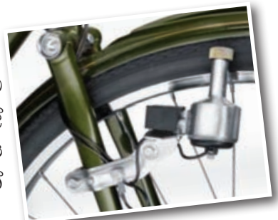
3.14 රූපය ▲ බයිසිකලයක් සඳහා ඩයිනමෝවක් සවිකර ඇති අයුරු
