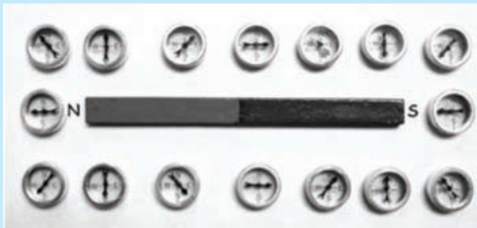
6.20 රූපය ▲ දණ්ඩ චුම්බකයක් වටා විවිධ ස්ථානවල දී මාලිමා දර්ශකයේ පිහිටීම
