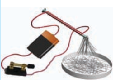
6.25 රූපය ▲ විදුලිය සපයා ඇති විට අල්පෙනෙති ආකර්ෂණය සිදුවේ.
