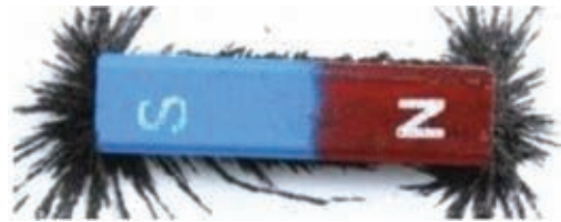
6.3 රූපය ▲ දණ්ඩ චුම්බකයක චුම්බක බලය පවතින අයුරු
