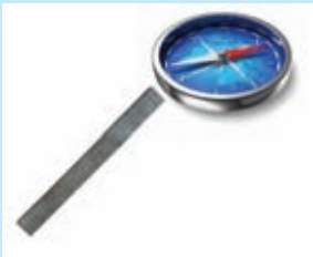
6.7 රූපය ▲ චුම්බක මාලිමාව භාවිතයෙන් චුම්බකයේ ධ්‍රැව හඳුනාගැනීම
