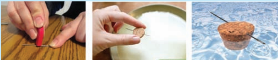
6.18 රූපය ▲ ඉඳිකටුවක් ආධාරයෙන් මාලිමාවක් සකසන අයුරු
