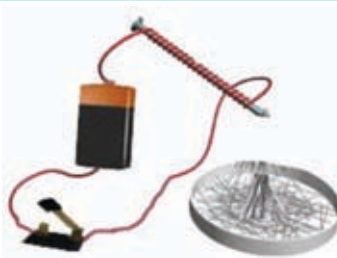
6.26 රූපය ▲ විදුලි සැපයුම විසන්ධි කළ විට අල්පෙනෙති ආකර්ෂණය නැතිවී යයි.
