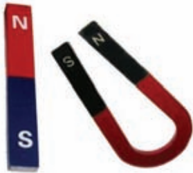
6.5 රූපය ▲ චුම්බකයක ධ්‍රැව සටහන් කර ඇති ආකාරය
