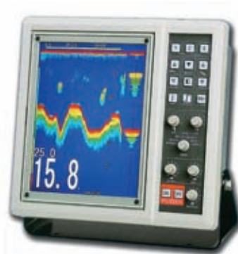
14.27 රූපය - ප්‍රතිධ්වනිමානයක මුහුදු පත්ල පිළිබඳ තොරතුරු සටහන් වී ඇති අයුරු
