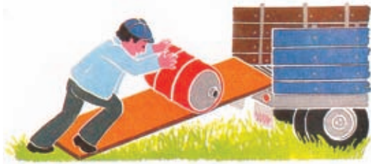
15.3 රූපය - ආනත තලයක් භාවිතයෙන් ලොරියකට තෙල් පීප්පයක් පැටවීම
