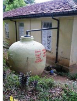
13.10 රූපය - නිවෙසක වැසි ජලය රැස් කිරීමට යොදා ඇති උපක්‍රමයක්
