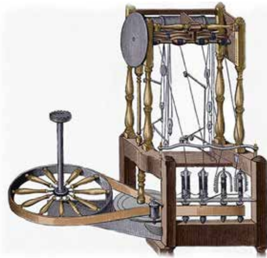
රූපය 1.2 - ටෙඩ් ආර්කරයිට් විසින් නිපදවන ලද ජල බලයෙන් ක්‍රියා කරන නූල් කට්න යන්ත්‍රය
