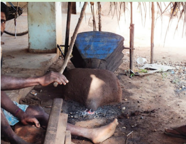
රූපය 1.11 වම්පසින් යකඩ කර්මාන්තය සඳහා භාවිතා කරනු ලබන මයිනහම දකුණු පසින් පුරාවිද්‍යා කැණීම්වලින් හමු වූ පැරණි යකඩ ඇණ කිහිපයක්
