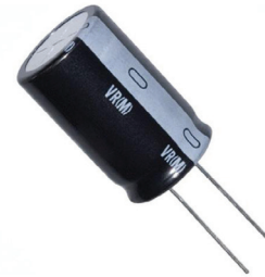
2.13 රූපය ▲ ධාරිත්‍රකයක රූපසටහනක්
