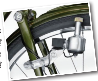
3.14 රූපය ▲ බයිසිකලයක් සඳහා ඩයිනමෝවක් සවිකර ඇති අයුරු
