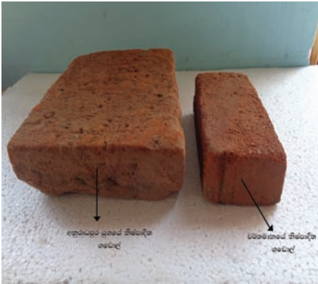
රූපය 1.20 අනුරාධපුර රාජ්‍ය සමයේ නිෂ්පාදනය කළ ගඩොල් සහ වර්තමානයේ නිෂ්පාදිත ගඩොල්
