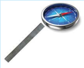
6.7 රූපය ▲ චුම්බක මාලිමාව භාවිතයෙන් චුම්බකයේ ධ්‍රැව හඳුනා ගැනීම
