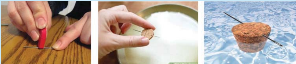
6.18 රූපය ▲ ඉඳිකටුවක් ආධාරයෙන් මාලිමාවක් සකසන අයුරු
