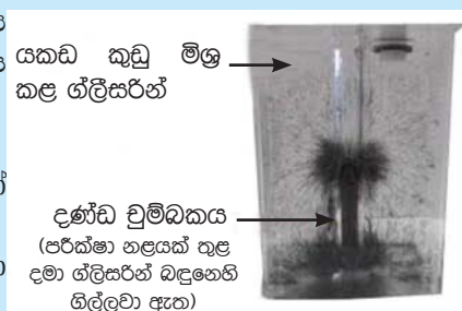
6.12 රූපය ▲ යකඩ කුඩු මිශ්‍ර කළ ග්ලිසරින් තුළ ගිල්වූ දණ්ඩ වුම්බකයක්
