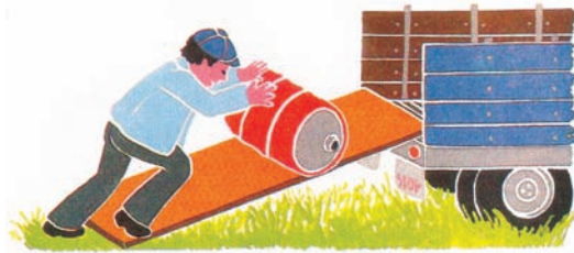
15.3 රූපය - ආහන තලයක් භාවිතයෙන් ලොරියකට තෙල් පීප්පයක් පැටවීම
