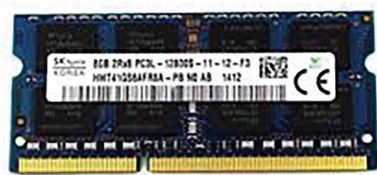
රූපය 1.12 - ප්‍රධාන මතකය ලෙස ක්‍රියා කරන RAM (Random Access Memory) කාඩ්පත
