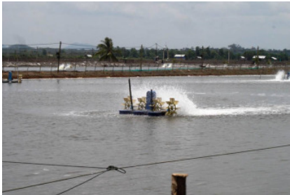
රූපය 5.20 - හබල රෙන්ද් ආධාරයෙන් පොකුණු වාතනය කරන අයුරු
