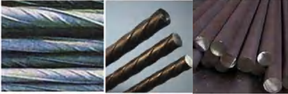
முறுக்கப்பட்ட உருக்கு நரம்புருக்கு மென்னுருக்கு உரு 3.37 கொங்கிறீற்றுக்கு வலுவூட்டும் கம்பி வகைகள்
