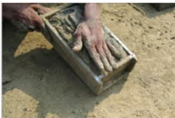
ගඩොල් අතින් නිෂ්පාදනය කිරීමේ දී හැඩ ගැන්වීම කරන අයුරු
