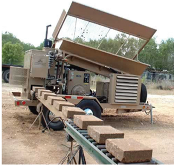
3.22 රූපය - සම්පීඩිත සීමෙන්ති පස් මිශ්‍ර ගඩොල් නිපදවන ආකාරය දැක්වෙන රූප සටහනක්
