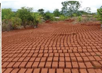
හැඩගැන්වීම කර ඇති ගඩොල් වියළීමට තබා ඇති අයුරු
