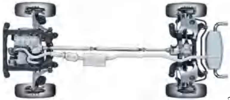
6.27 රූපය ජව සම්ප්‍රේෂණය සඳහා අවර පෙති කඳ යොදා ගැනීම.
