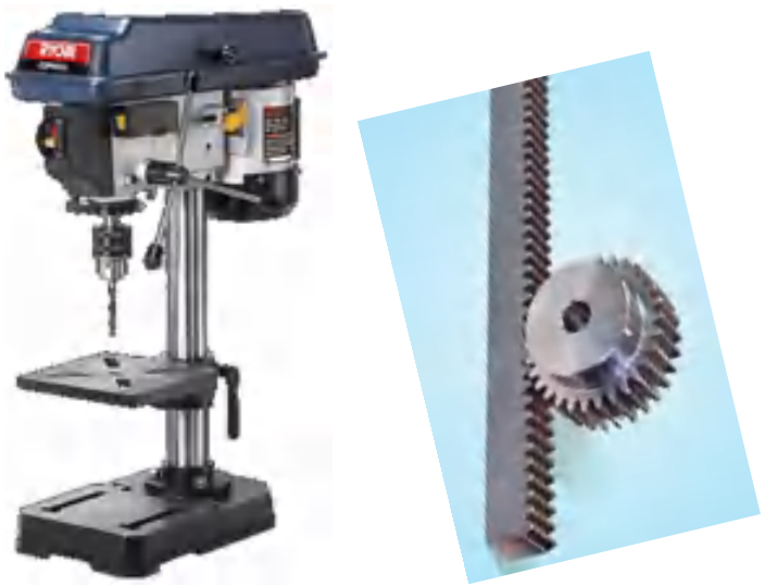
3.18 රූපය - විදුලියෙන් ක්‍රියාකරන බංකු විදුම් යන්ත්‍රයක් හා එහි ඇතුළත් යාන්ත්‍රණ
