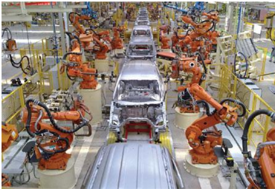
රූපය 1.4.2 - පරිගණකය මගින් පාලනය කෙරෙන රොබෝවරුන් භාවිතයෙන් මෝටර් රථයක් එකලස් කිරීම
