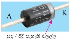
සූදු / 51C පැහැති වලල්ල 11.9 රූපය - සන්ධි ඩයෝඩයක සාමාන්‍ය බාහිර ස්වරූපය
