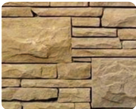
4.51 රූපය - රළු මතුපිට සහිත ව සකසන ලද ග්‍රැනයිට් කොටසක්
