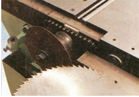
உரு 1.50 வாள் அலகைத் தீட்டுதல் (Sharpen saw blade)
