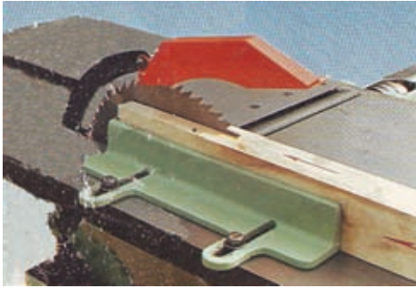
உரு 1.43 மரம் அரிதல் (Sawing)
