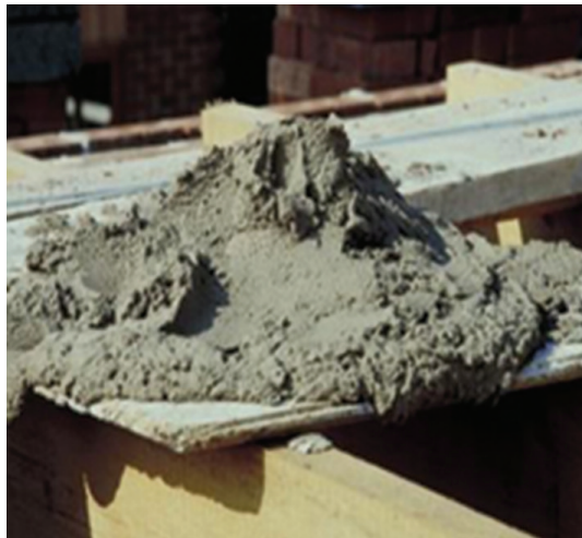
4.23 රූපය - කපරාරු කිරීම සඳහා බදම ලෑල්ලට ගත් හුනු සිමෙන්ති බදමයක්
