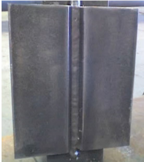
වායු වෙල්ඩින් කිරීම මගින් ස්ථිර ව සම්බන්ධ කර ඇති කුඩා තහඩු දෙකක්
