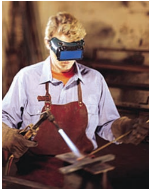
3.3 රූපය - වායු වෙල්ඩින් කිරීම මගින් ලෝහ කොටස් සම්බන්ධ කිරීම
